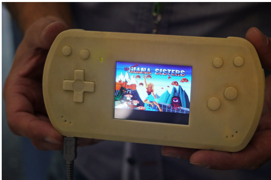
FPGA goes mobile: Marco Willigs Handheldsystem im Prototypen-Gehäuse und dem portierten Amiga-Kern.
