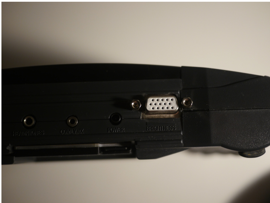
Die VGA-Buchse ersetzt den Helligkeitsregler.
