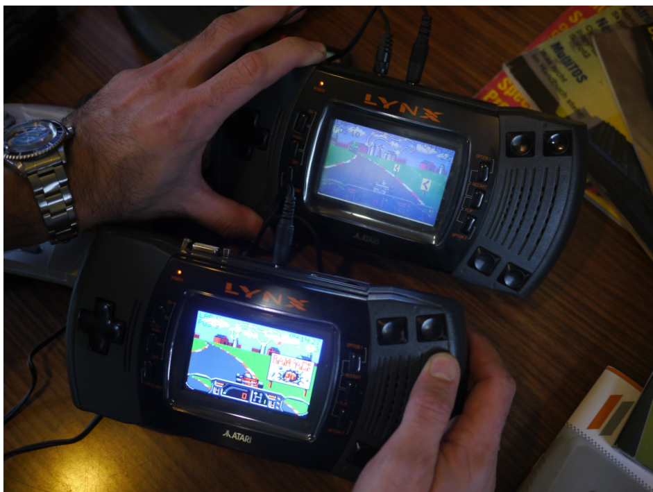
Vergleich 2: Checkered Flag auf einem Lynx mit und einem ohne VGA-Umbau.
