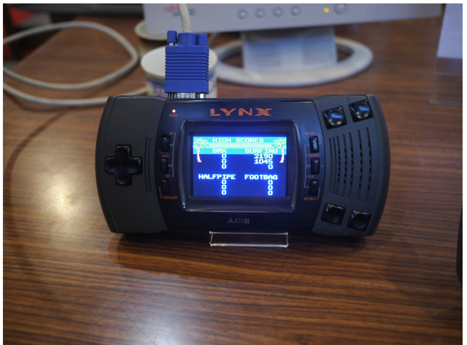
Lynx mit VGA-Anschluss auf dem ejagfest. Mit der Backlight-Taste wird zwischen Display und TV/Monitor umgeschaltet.
