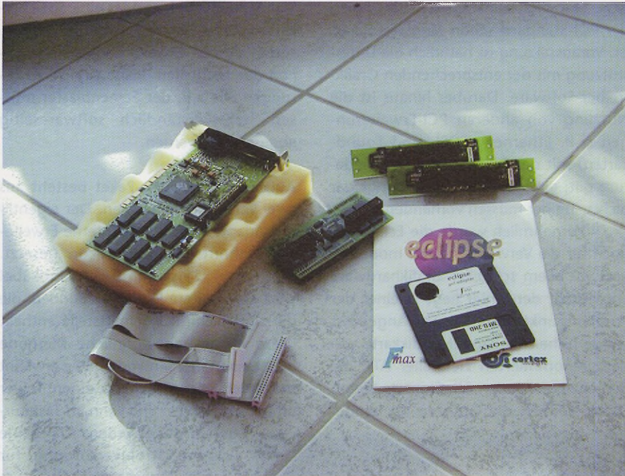
Zum Lieferumfang der Eclipse gehören (im Uhrzeigersinn) die ATI Rage II, der Eclipse-Adapter für den internen Erweiterungsbus des Falcon, zwei PCI-Steckleisten, ein exzellentes deutschsprachiges Benutzerhandbuch, eine Treiberdiskette sowie das nötige Flachbandkabel. Die Qualität der einzelnen Elemente und der deutsche Support durch Frontier Systems ist hervorragend.
