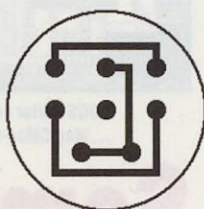
Abb. 3: Die Verdrahtung des LAN-Prüfsteckers
