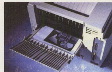
Durch diese Klappe im Heck des Mannesmann verläßt das Papier den Drucker nahezu ungekrümmt.
