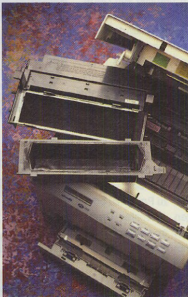
Einmal montiert, läßt sich beim Olivetti der Toner-Behälter nur fürs Foto von der Entwicklungseinheit trennen.
