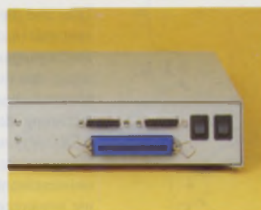
SCSI Schnittstelle an Geräterückseite herausgeführt
