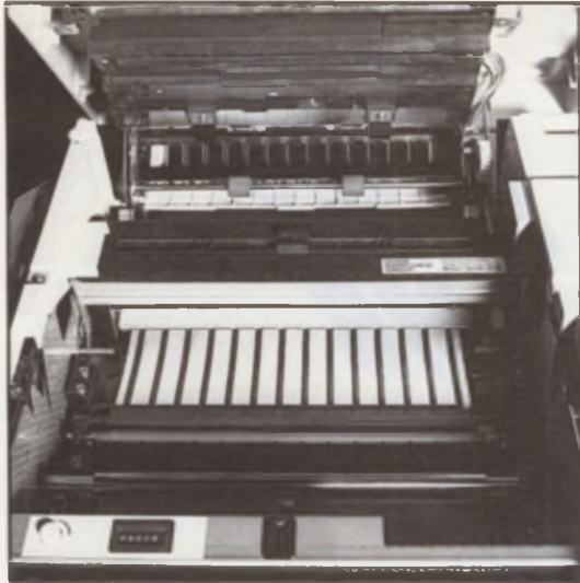
Das Innere, nachdem die Trommel- und Entwicklereinheit entfernt wurden. Hinten die Fixierstation, im Deckel der Laser. Im Vordergrund der Seitenzähler.
