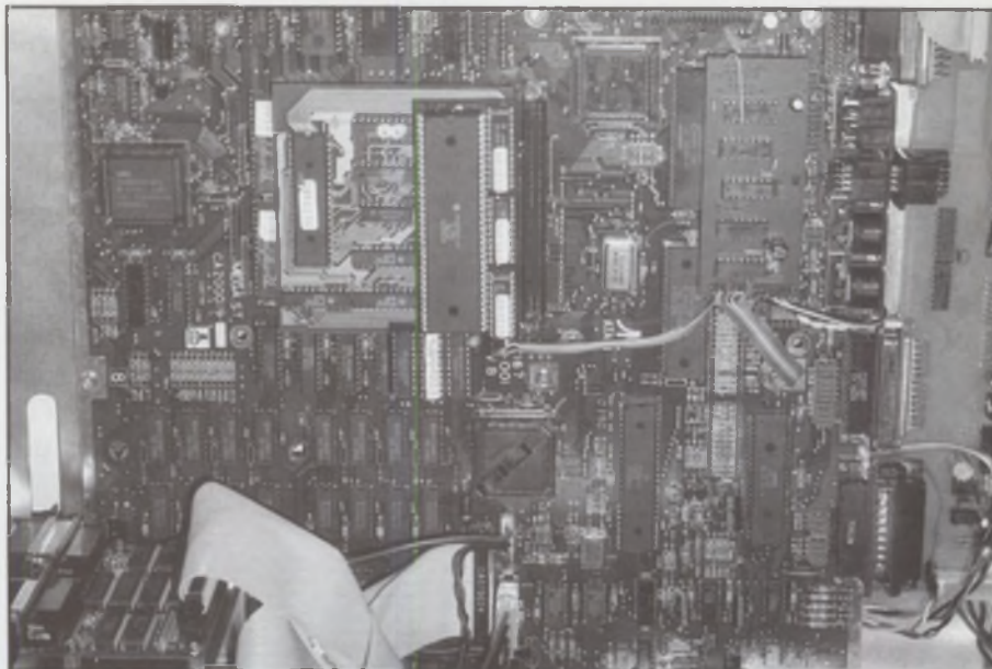
Das Innenleben unseres Testgerätes. Deutlich erkennbar sind PC-Speed mit aufgesetzter 16 MHz-Erweiterung und die blaue Platine für den Anschluß des HD-Laufwerks.
