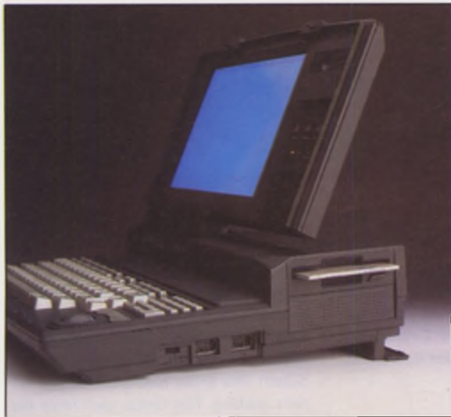
Bild 2: Die Ports des STACY sind alle hinter Klappen verborgen, die sich aber leicht abnehmen lassen (sollten). Links neben den beiden Buchsen sieht man den Umschalter zwischen Trackball und Maus/Joystick. Ärgerlich ist, daß das Display von seitlich nicht lesbar ist.
