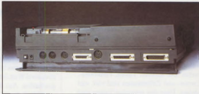
Bild 1: Die Kehrseite von STACY mit allen gewohnten Schnittstellen und rechts oben dem Batteriefach.
