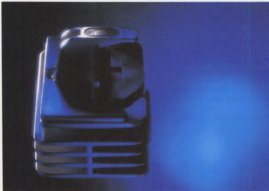
Der Druckknopf des TLQ-4800. Deutlich sieht man die Nadeln
