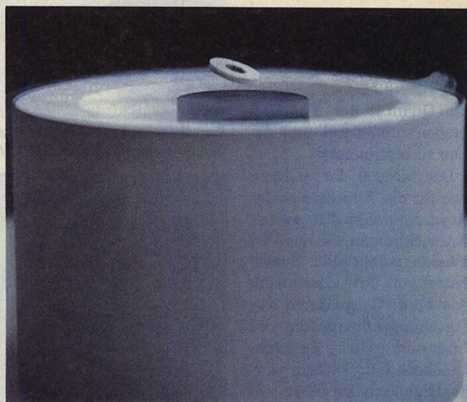
Spiel mit dem Magnet: Ein Supraleiter hebt wie von Geisterhand gesteuert ab.
