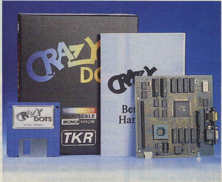
Schöne bunte Welt: 256 aus 260 000 Farben und eine maximale Auflösung von 1664 x 1200 Bildpunkten bietet die Grafikkarte »Crazy Dots«
