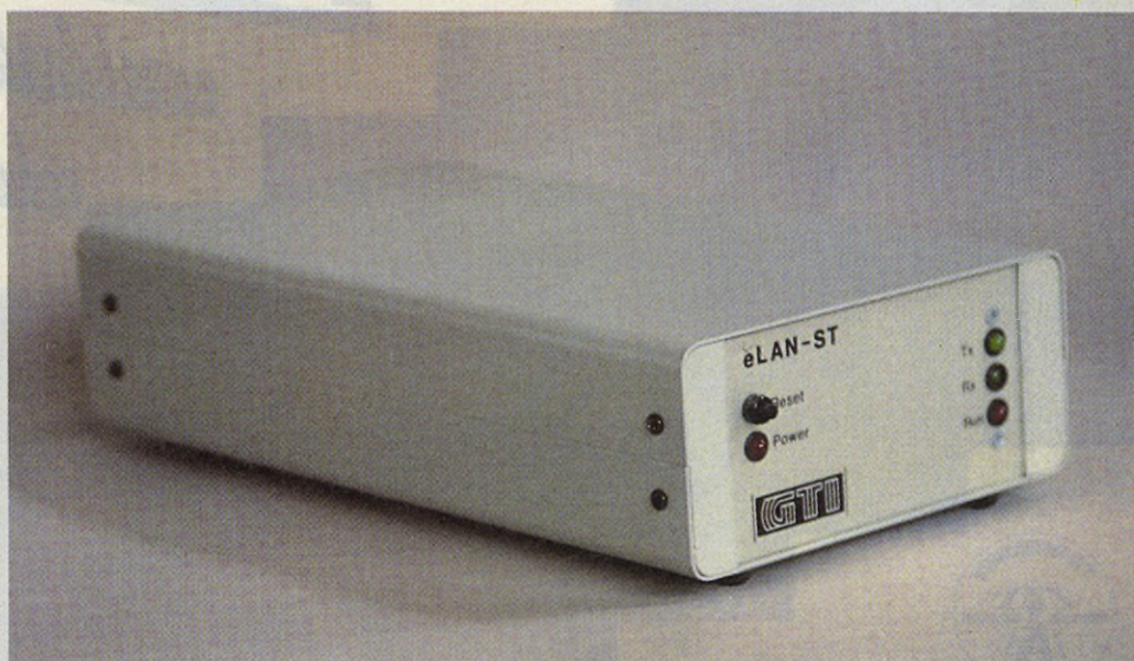
Der GTI-Netzknoten belegt zwei DMA-Adressen
