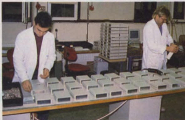
Bei diesem Arbeitsgang finden die Platinen ihren Platz im SuperCharger-Gehäuse
