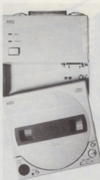
CD-ROM mit 540 MByte in tragbarer batteriebetriebener Form
