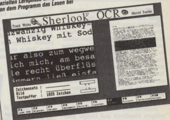
Bild 5. Invertieren eines Bildabschnitts verhindert, daß Sherlook hier versucht, einen Text zu lesen
