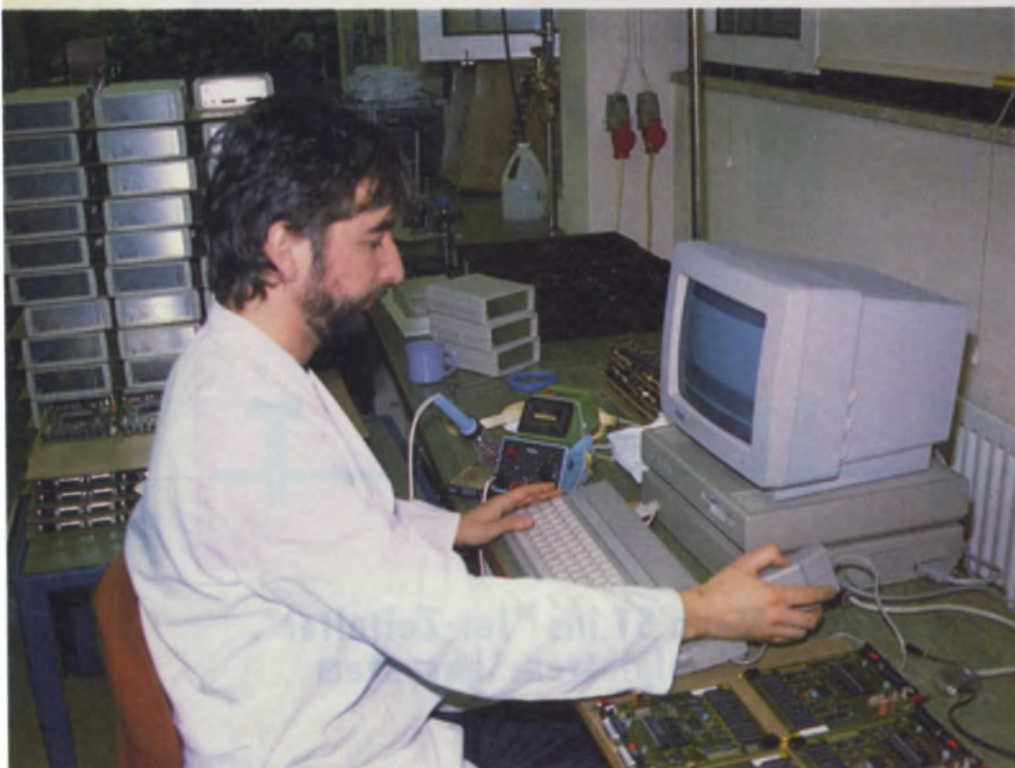
Nach der Bestückung wird jede einzelne Platine mit einem Testprogramm geprüft
