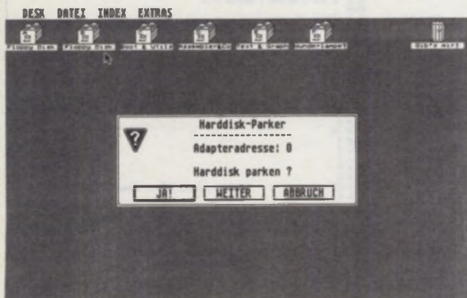
Die Adapteradresse Target 0 bis 7 können Sie in diesem Fenster auswählen um die Hard-Disk zu parken
