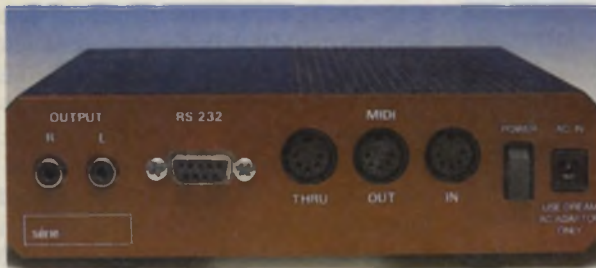
Das Expandermodul »SAM-XP« verfügt neben den MIDI-Buchsen über Stereo-Ausgänge und eine RS232-Schnittstelle
