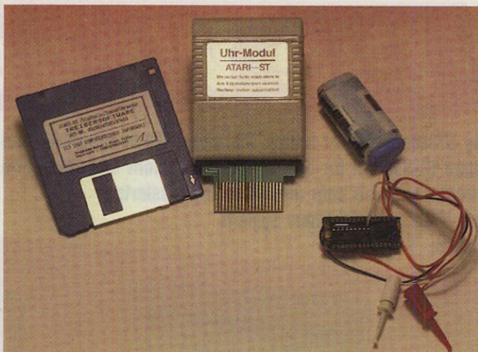
Zaporowskis Uhr-Modul steckt am ROM-Port und benötigt Treibersoftware. Die Mega-Clock steckt im Computer und läuft beim Blitter-TOS ohne zusätzliche Software
