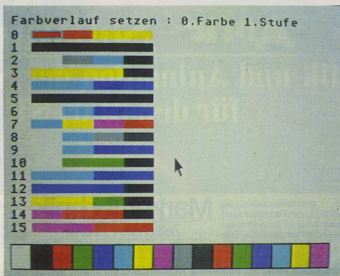
Bild 1. Mit dem Raytrace-Animator gestaltet sich die komplexe Zusammenstellung der Farbpalette für Tom Hudsons Raytracer einfach und anschaulich. Für bis zu 10 Strahlreflexionen lassen sich die Farben aus der Tabelle blitzschnell zusammenschneiden.
