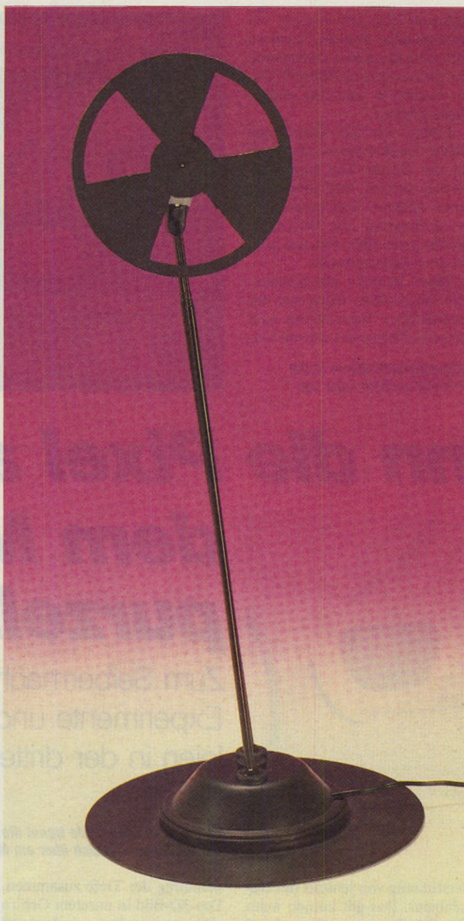
Bild 3. So einfach geht's: Ein Gestell, ein Synchron-Motor und eine Pappscheibe mit 60-Grad-Segmenten für die ersten Schritte zur räumlichen Computergrafik.
