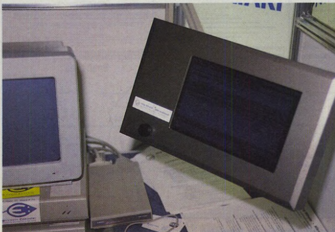
Bild 2. Als vollwertige Alternative präsentiert sich der LCD-Bildschirm am ST. Zusammen mit dem Schwenkarm bietet er einen vorbildlich ergonomischen Arbeitsplatz. Es ist mit 2500 Mark um ein Vielfaches teurer als der monochrome Monitor. Das dürfte sich in absehbarer Zeit ändern. Die DST-LCDs werden in Stückzahlen schon für 500 Mark angeboten.
