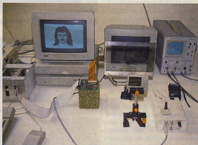
Erster Schritt zum wirklich fälschungssicheren Personalausweis: das digitalisierte Foto wird auf die LC-Anzeige übertragen
